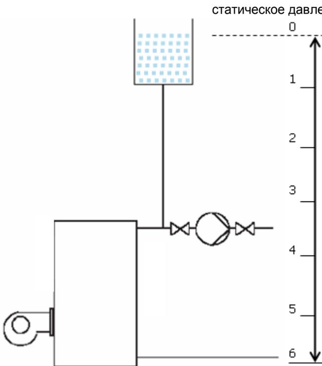
В случае систем с открытым расширительным баком, высота установки бака определяет статическое давление в системе.
