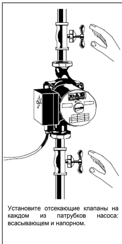
Установите отсекающие клапаны на каждом из патрубков насоса: всасывающем и напорном.
