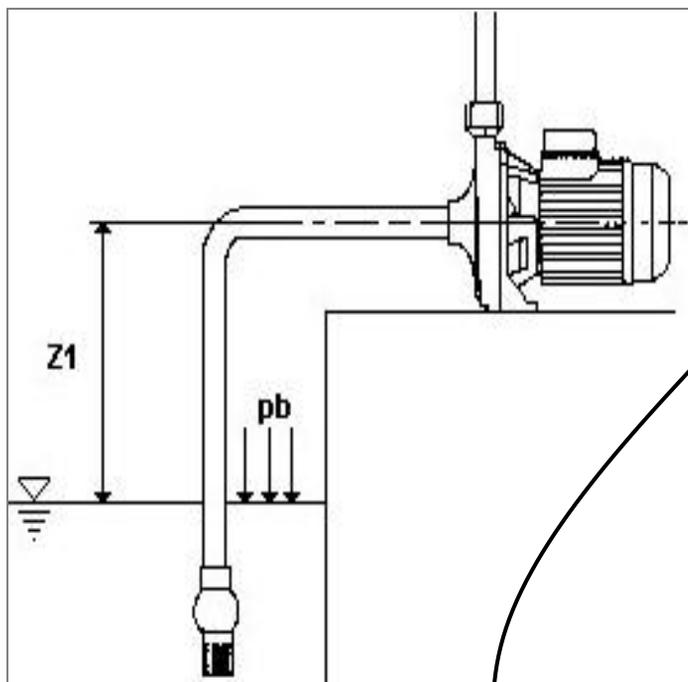
✓ **pb** = барометрическое давление (в метрах водяного столба) на месте установки насоса (зависит от высоты над уровнем моря, см. табл. 2 на следующей странице))
