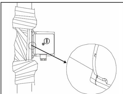
Если на корпус насоса установлена тепловая изоляция, проверьте, чтобы дренажные отверстия из статорной полости не были закрыты.
