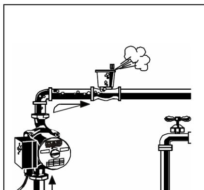
После заполнения системы удалите воздушные пробки до включения насоса. Включайте насос на максимальной скорости.
