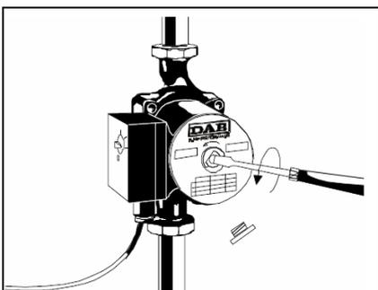
В основном, циркуляционный насос не требует какого-либо технического обслуживания. В начале каждого отопительного сезона, перед включением насоса, убедитесь, что вал насоса не заблокирован отложениями. Для этого отвинтите пробку в торце статора и шлицевой отверткой проверните вал.
