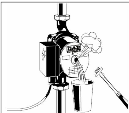
Когда система запускается в первый раз, а также после каждого слива теплоносителя, необходимо удалить воздух из двигателя: медленно отвинтите пробку в торце статора и подождите, пока из отверстия не пойдет жидкость, через несколько секунд заверните пробку.
