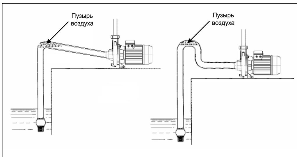
В некоторых системах всасывающая линия насоса имеет форму показанную на рисунках выше. В данных случаях в точках перегиба трубопровода образуются трудноудаляемые воздушные пробки, которые сильно уменьшают эффективное сечение трубопровода, а в некоторых случаях могут привести к неспособности насоса всасывать воду.
