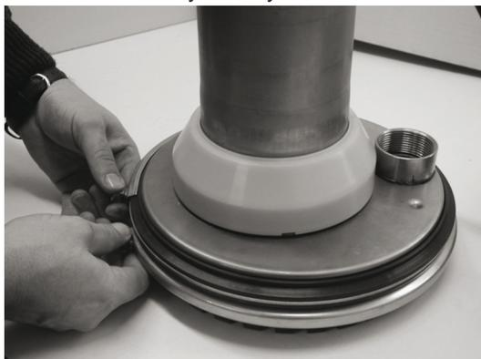
3. Вкрутить болт 914.03 в замок стяжной скобы.
