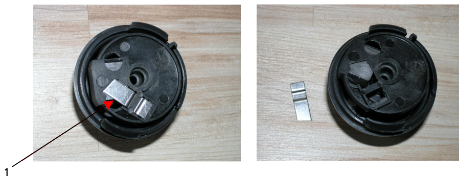
Рис. 8: Снятие стальной пластинки
