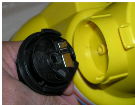
Рис. 7: Извлечение устройства автоматического переключения
