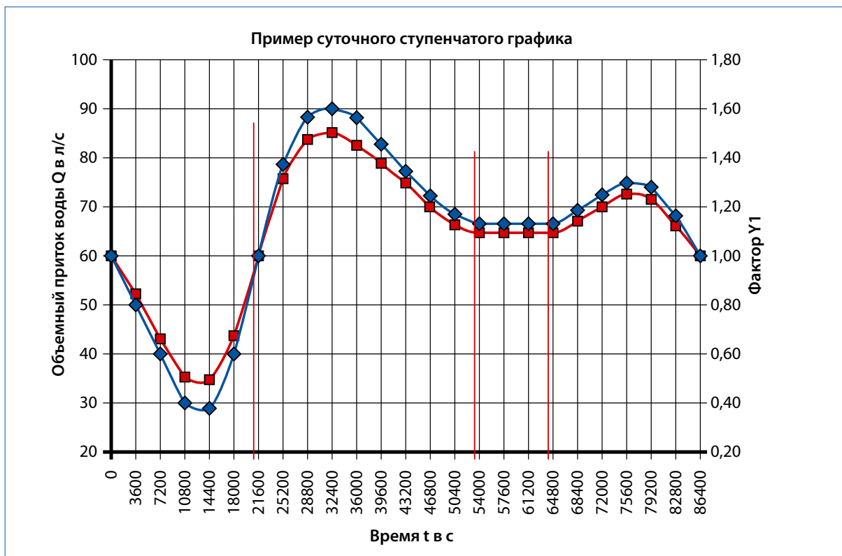
Рис. 1: Пример ступенчатого графика притока сточной воды для математической модели вычислений при подборе насосов
