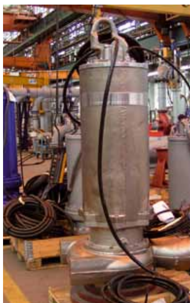
Рис. 2.4: Насос KRT для морской воды, выполненный из дуплексной стали
