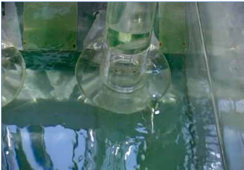
Рис. 5.1: Вихрь в макете насоса, засасывающий воздух
