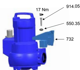
Рис. 13: Установка крепеж-захвата при тросовых направляющих, 1 штанговой направляющей и хомуте.
