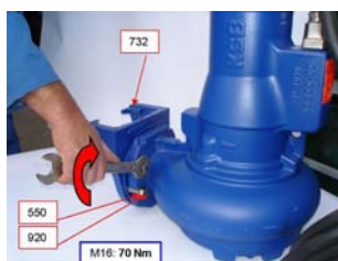
Рис. 14: Установка крепления при наличии 2-штанговой направляющей
