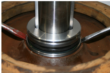
Рис. 18: Извлечение торцового уплотнения с помощью монтировок
