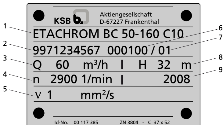
Рисунок 5: Заводская табличка Etachrom BC
