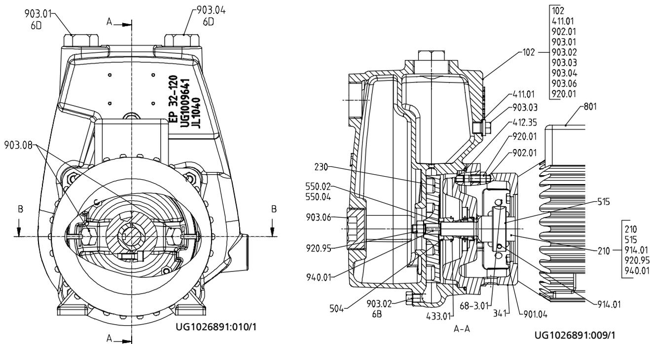
Рисунок 9: Исполнение: Торцевое уплотнение одностороннего действия
