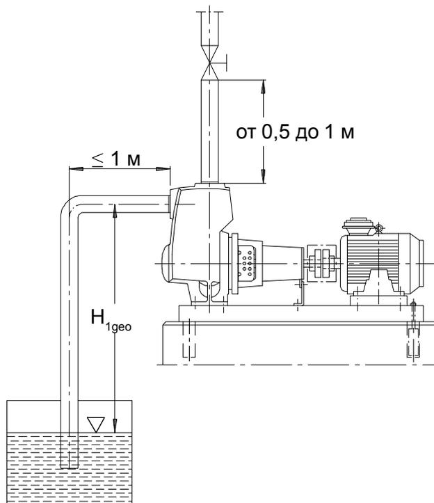
Рисунок 5: Расстояния до всасывающего и напорного трубопроводов.
