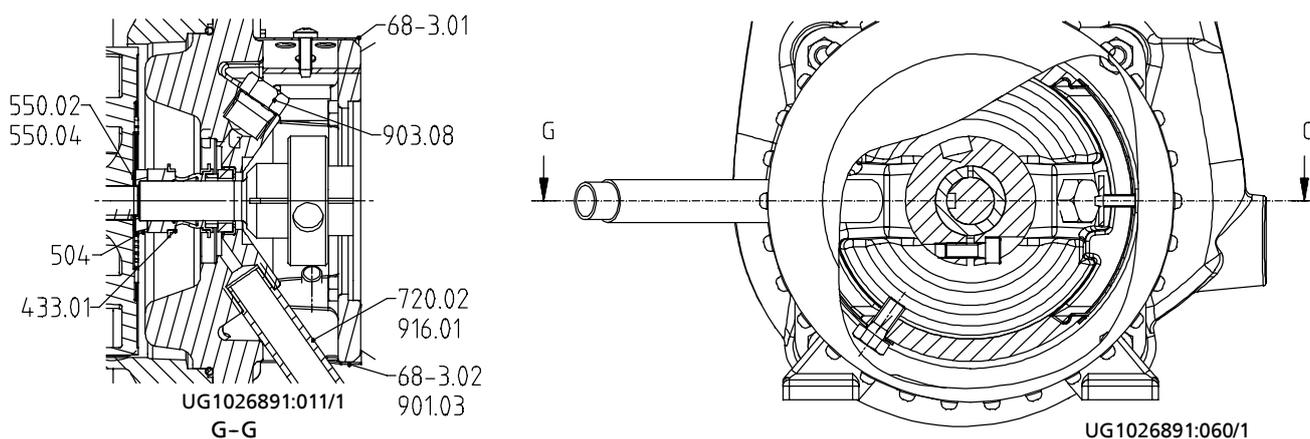
**Рисунок 10:** Исполнение: Торцевое уплотнение одностороннего действия с промывкой
