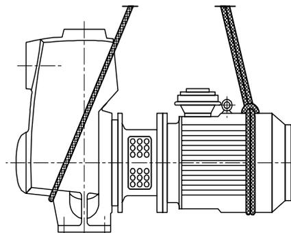
Рисунок 2: Транспортировка насосного агрегата
