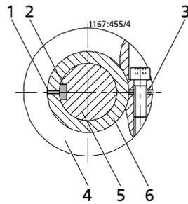
Рисунок 7: Установка конца вала двигателя на вал
