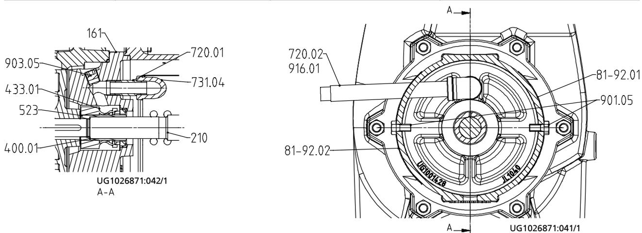
**Рисунок 14:** Исполнение: Торцевое уплотнение одностороннего действия с промывкой
