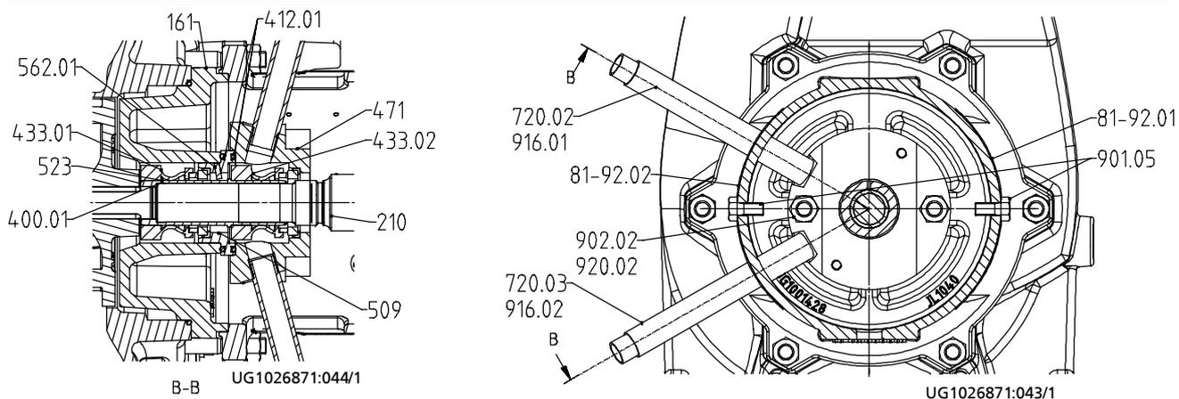
**Рисунок 15:** Исполнение: Двойное торцевое уплотнение с расположением по схеме "тандем"
