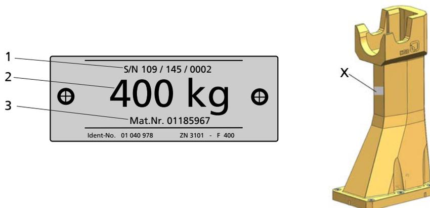
Рис. 3: Заводская табличка и пункты заводской таблички (X)
