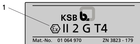
Рисунок 2: Пример: Дополнительная табличка для взрывозащищенных насосов
