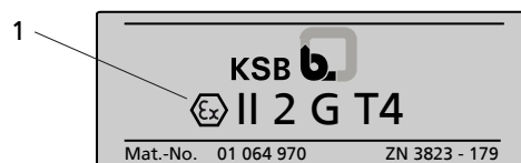
Рисунок 2: Пример: Дополнительная табличка для взрывозащищенных насосов
