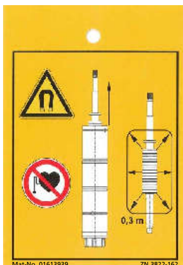
Рис. 2: Предупреждающая наклейка, которую нужно приклеивать на двигатель при возврате.
